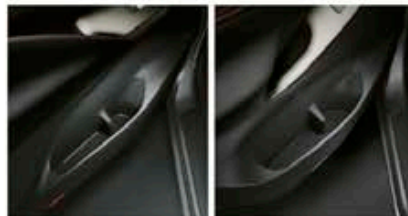
Sujetabotellas (guarnición de las puertas delanteras y traseras): Para los asientos de la primera y segunda fila se encuentran en la guarnición de las puertas delanteras y traseras.
