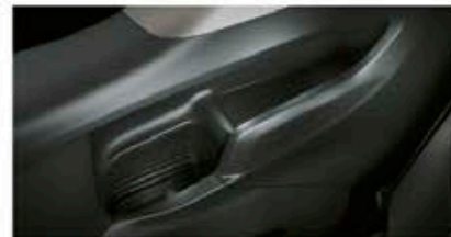
Sujetabotellas (guarnición lateral de la caja de carga): Para los asientos de la tercera fila se encuentran en la guarnición lateral de la caja de carga. Incluyen un compartimiento de almacenamiento.
